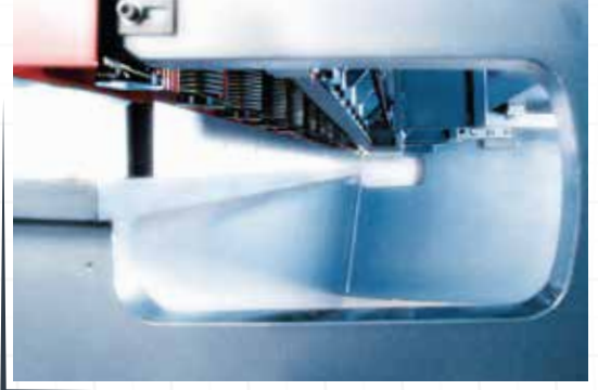
■ Boğaz Derinliği Minimum 350 mm olan boğaz derinliği bıçak boyundan daha uzun sacların kesilmesine olanak sağlar.
