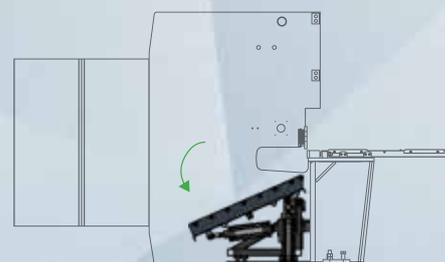
Schritt 1 Vor dem Schneiden unterstützt das Blechstützsystem mit pneumatisch angetriebenen Hilfsmitteln das Blech nach oben, wie auf dem Bild dargestellt
