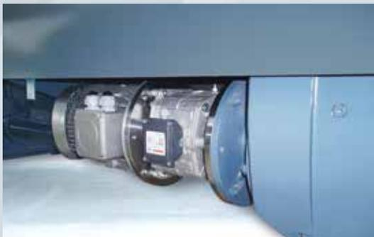
DURMA Magnetbremse und Kupplungssystem ist zum Starten, Stoppen, Positionieren, Steuern und Regeln der Bedingungen.
