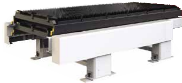
Wechseltisch mit Servo Motoren : Standard HD-F 3015, Option HD-F 4020
