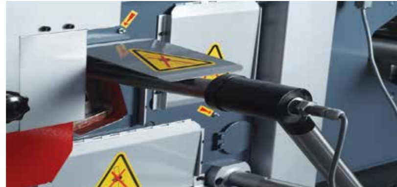
Otomatik Elektrikli, Dokunduğunda Kesme İşlemi Yapan Arka Dayama
