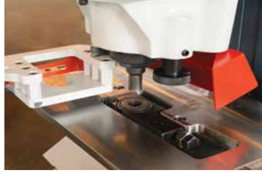
Kolay Açılabilen Sıyrıcı Sistemi
