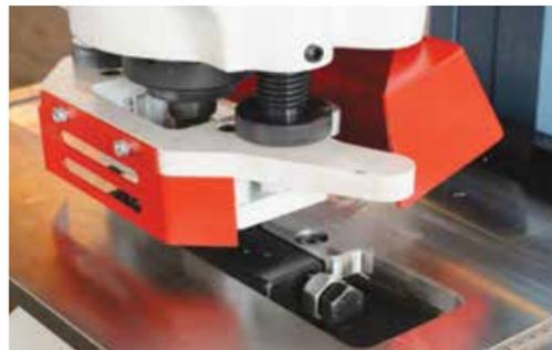
NPU-NPI und Flansch Bohrung
