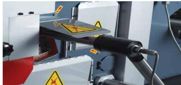
Automatische, elektrische Rückstütze die auf Berührung den Schnitt durchführt
