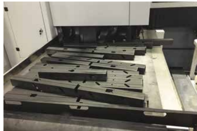
Konveyörlü otomatik boşaltma sistemi ile 6m uzunluğa kadar boru ve profiller tahliye edilir.
