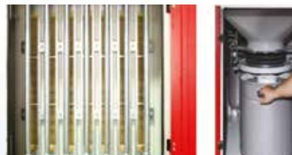
Einfacher Zugriff auf Filter und Staubbehälter
