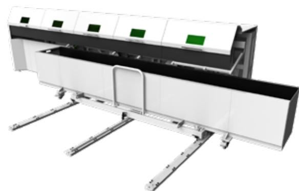
Wenn die Länge der geschnittenen Rohre und Profile mehr als 800 mm beträgt, nimmt die Entladeeinheit die Rohre und Profile und schützt sie vor dem Herunterfallen und führt sie aus.
