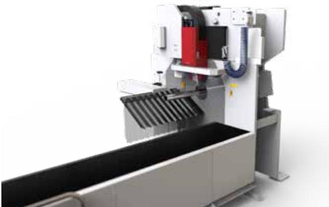
Wenn die Länge der geschnittenen Rohre und Profile weniger als 800 mm beträgt, werden die kleinen Reststücke in den Sammelbehälter abgelegt.
