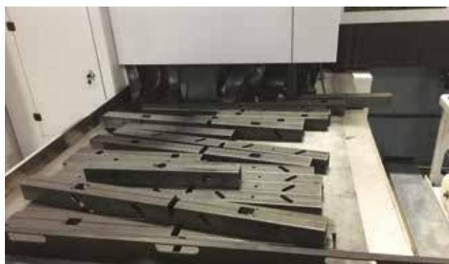
Das automatische Fördersystem übernimmt jedes Rohr und Profil bis zu 6 m Länge und führt es nach draußen.
