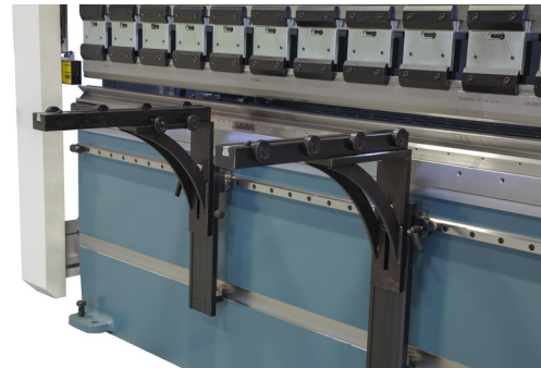
Vorderes Stützsystem für Bleche, mit Linearführung (L)
