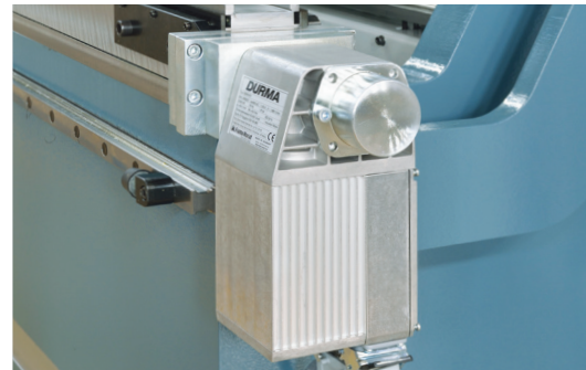
Bombierungssystem mit CNC-Steuerung
