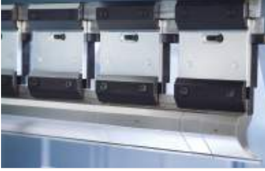
Avrupa Tipi Standart Kalıp ve Sıkma Sistemi
